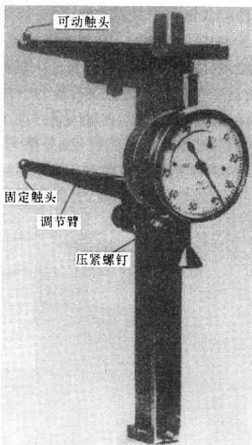
图 30 用于规格小于 4½ 的内螺纹锥度量规
